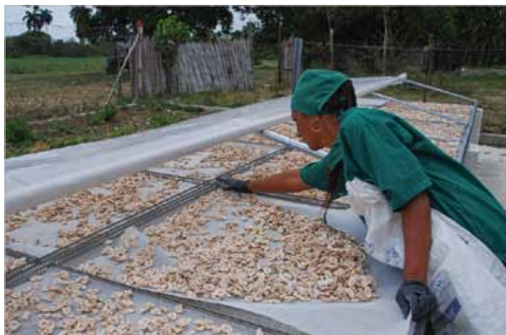
Entnahme der getrockneten Kochbananenscheiben aus dem Solar-Tunneltrockner durch die Arbeiterin Ania in der Kooperative Ángel Bouza.
